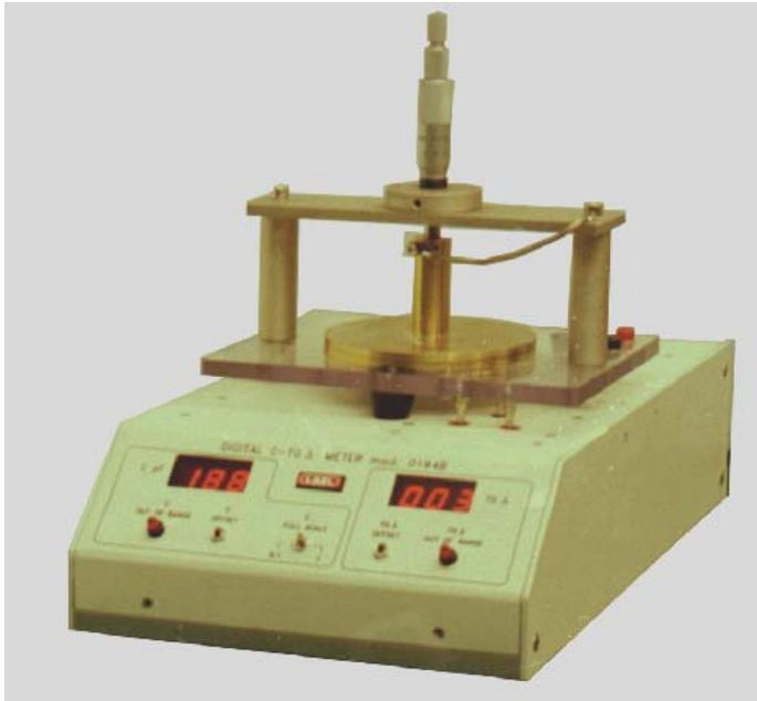
E' uno strumento da laboratorio destinato alla caratterizzazione elettrica dei film plastici. Esegue la misura della capacità e della tangente dell'angolo di perdita ( $\text{tg } \delta$ ) alla frequenza di 1 Mhz con ampiezza del segnale di eccitazione di 1 V.
